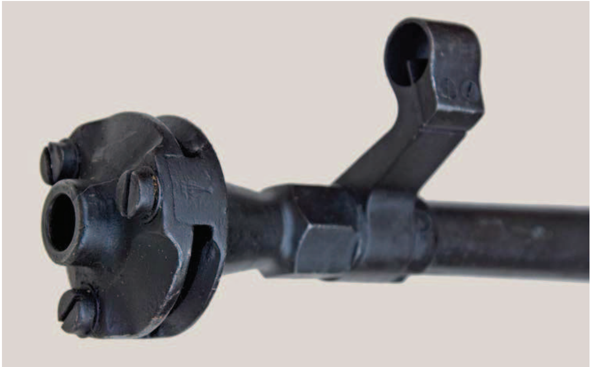
Fig. 3 - Il freno di bocca di primo tipo del Boys matricola C1540.
